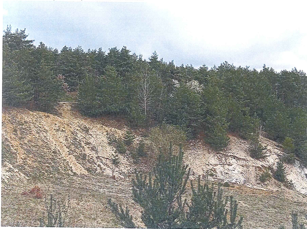
Fot. 13 i 14 Widok ogólny ze skarpy północno-zachodniej na część północną terenu zagrożonego ruchami masowymi ziemi; widoczna niezadarniona skarpa od strony lasu, obsypujący się materiał piaszczysto-gliniasty, obrywy; skarpy niezabezpieczone, nieustabilizowane.
